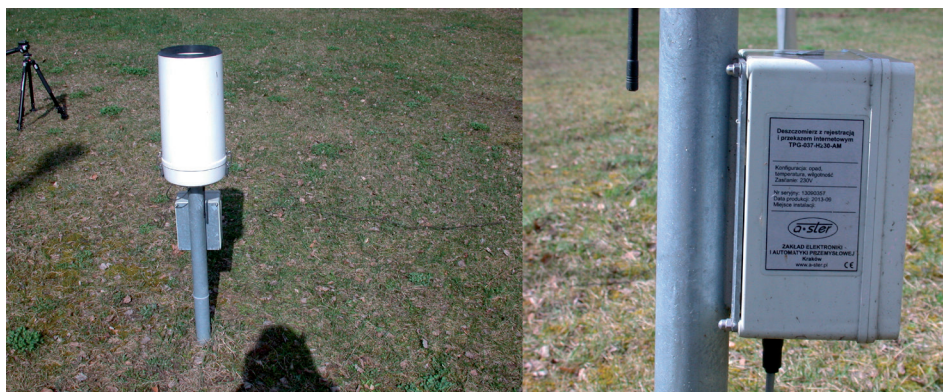
Ryc. 3. Deszczomierz samorejestrujący opad na jednym z posterunków (fot. W. Radziun) Fig. 3. The automatic rain gauge on the one of the measurements site (photo by W. Radziun)
