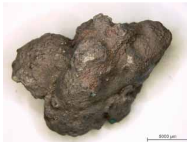
Ryc. 26. Odpad procesu topienia brązu — próbka nr 1474
