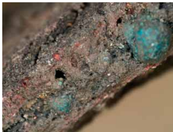
Ryc. 40. Fragment tygła (próbka nr 656) z widocznymi kroplami stopu, powiększenie 20×
