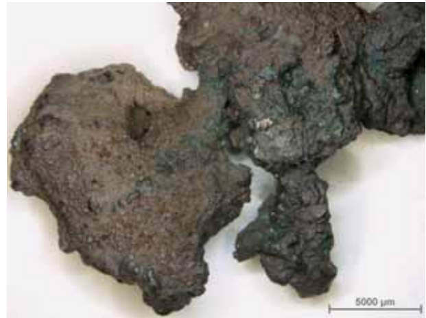
Ryc. 3. Produkt procesu topienia brązu — próbka nr 576
