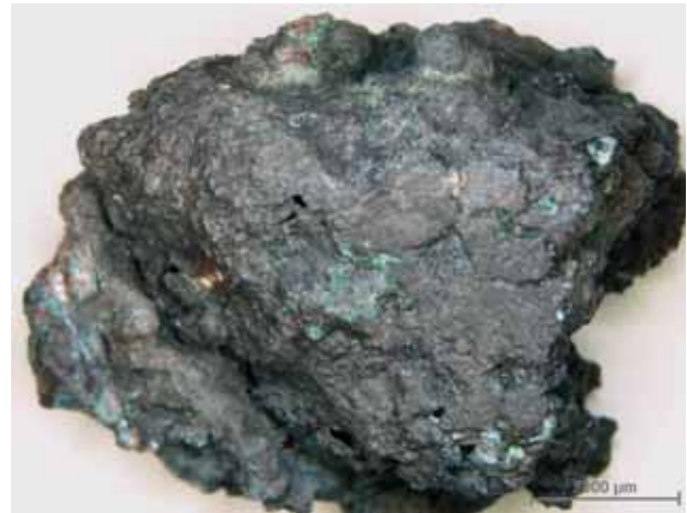
Ryc. 15. Produkt procesu topienia brązu — próbka nr 506
