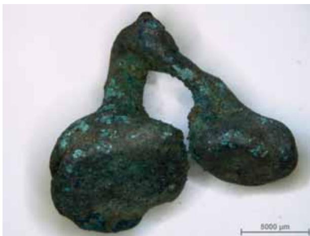
Ryc. 21. Produkt procesu topienia brązu — próbka nr 514
