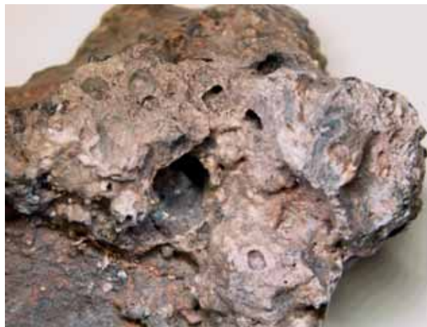
Ryc. 50. Żużel — próbka nr 14060 (2)
