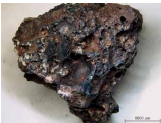
Ryc. 54. Żużel — próbka nr 14060 (6)
