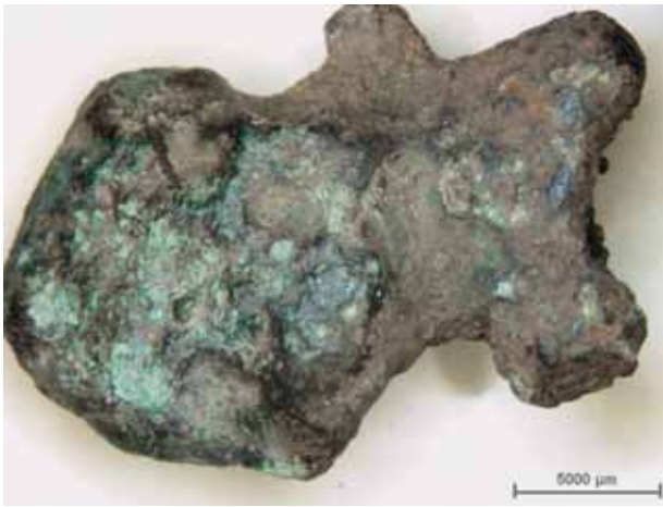
Ryc. 1. Produkt procesu topienia brązu — próbka nr 519
