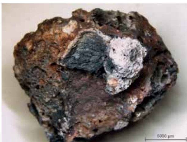
Ryc. 52. Żużel — próbka nr 14060 (4)
