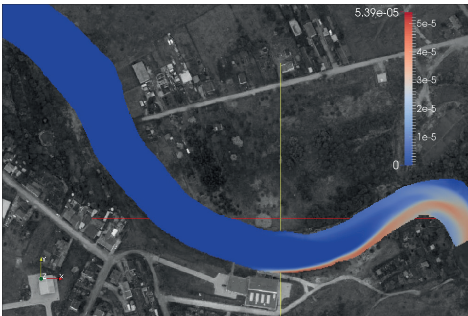
Ryc. 5. Uwolnienie paliwa w okolicach środka rzeki, stany wody średnie, czas symulacji: 480 s ( \text{dm}^3/\text{dm}^3 )
