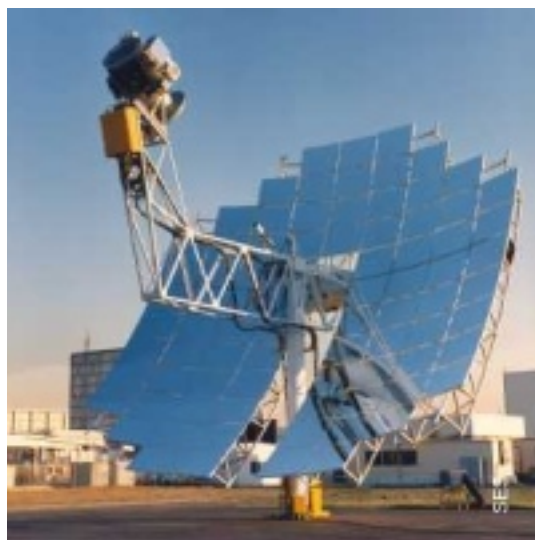
Rys. 2.4: Paraboliczne lustro skupiające promienie słoneczne na silniku Stirlinga
