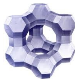
Rys. 1. Struktura przestrzenna zeolitu X
