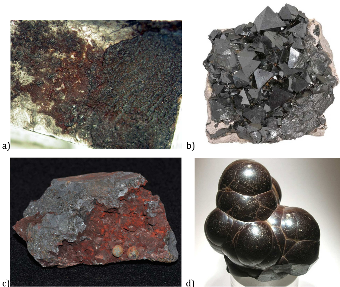
Rysunek 1.32 Wygląd kryształków tlenków żelaza: a) wustyt (czarna część) b) magnetyt, c) maghemit, d) hematyt [124–127].
