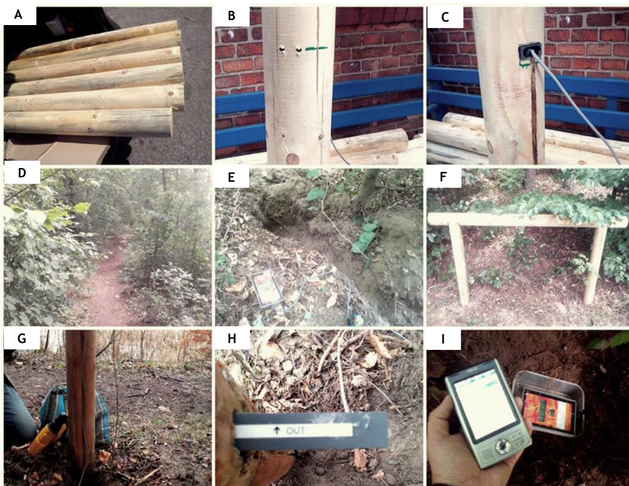
Ryc. 11. Sposób montażu i zabezpieczenia czujników pyroelektrycznych typu Eco-Twin z logerem do automatycznego zliczania ruchu turystycznego na szlaku turystycznym na stanowisku Bachotek
