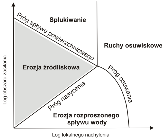
Ryc. 8. Domeny procesów odpowiedzialnych za inicjację koryta rzeczne według D.R. Montgomery'ego i W.E. Dietricha (1994), zmienione
