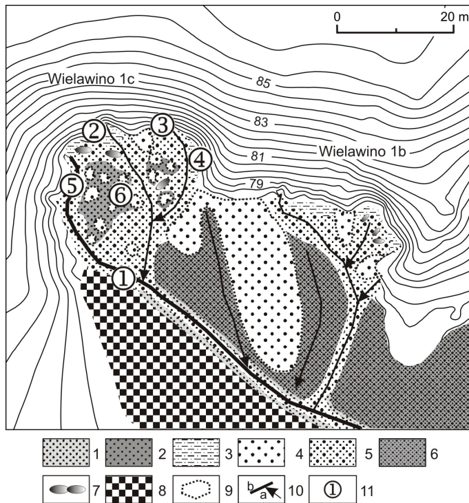
Ryc. 73. Szkic geologiczny niszy źródłkowych Wielawino 1b i c na stanowisku Wielawino 1
