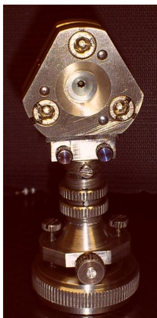
Rysunek 2.2.1. Wysokociśnieniowa komora diamentowa z dyskami stalowymi zamontowana na głowicy goniometrycznej.
