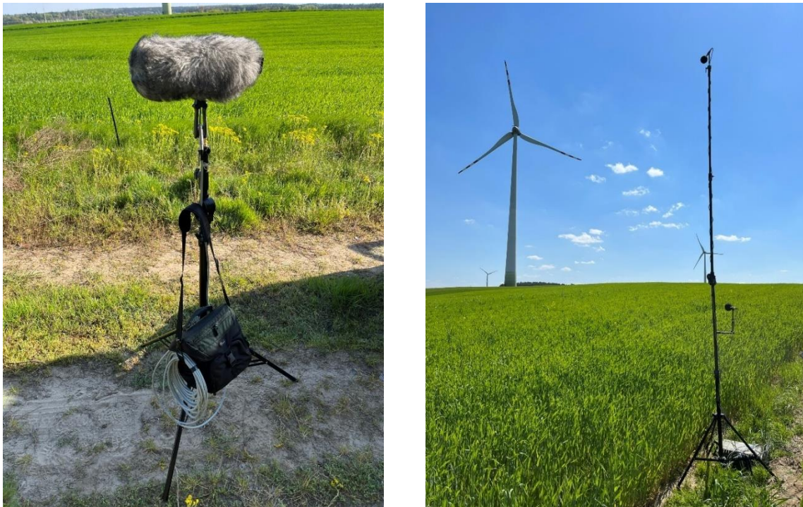
Rys. 13-3 Po lewej: mikrofon ambisoniczny 4. rzędu RODE NTSF1 z systemem akwizycji Artemis SQuadriga II, ustawione na statywie na wysokości 1.5 m.n.p.t.; po prawej: miernik poziomu dźwięku SVAN 979, mikrofony umieszczono na wysokości 4 m i 1.5 m n.p.t.
