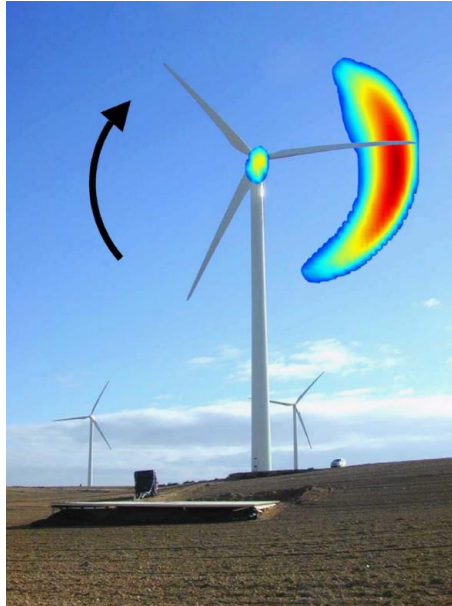
Rys. 5-2 Lokalizacja głównego elementu TW stanowiącego źródło hałasu krawędzi sptywu - łopata opadająca (źródło ilustracji: [31])
