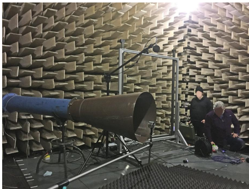
Rys. 13-5 Tunel aerodynamiczny w komorze bezdechowej Instytutu Techniki Ciepłej w Łodzi
