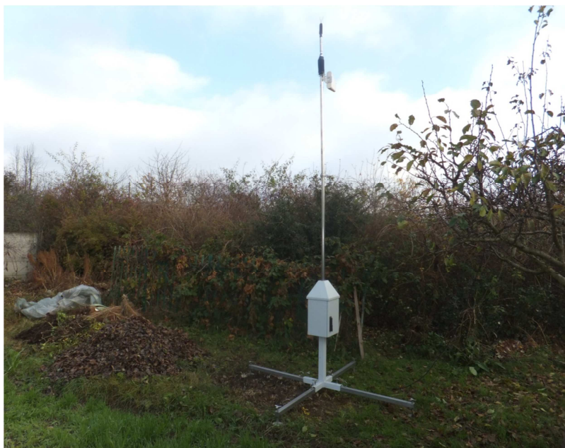
Rys.5.1. Stacja monitoringu hałasu – wysokość punktu pomiarowego h = 4 m
