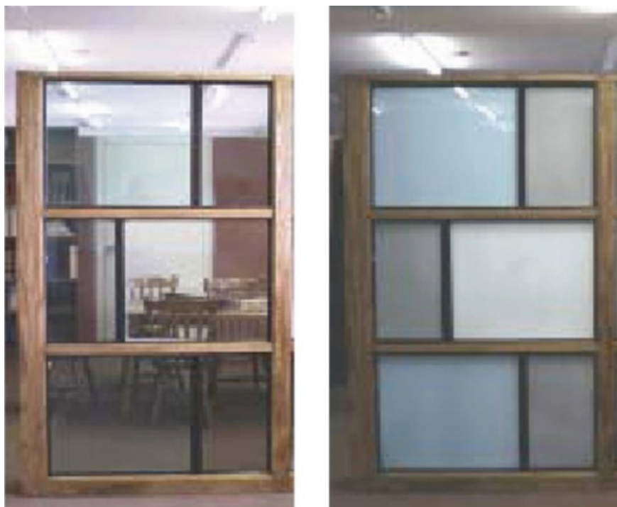
Zdjęcie 8. Okno termotropowe w różnych temperaturach – zjawisko zmętniania
