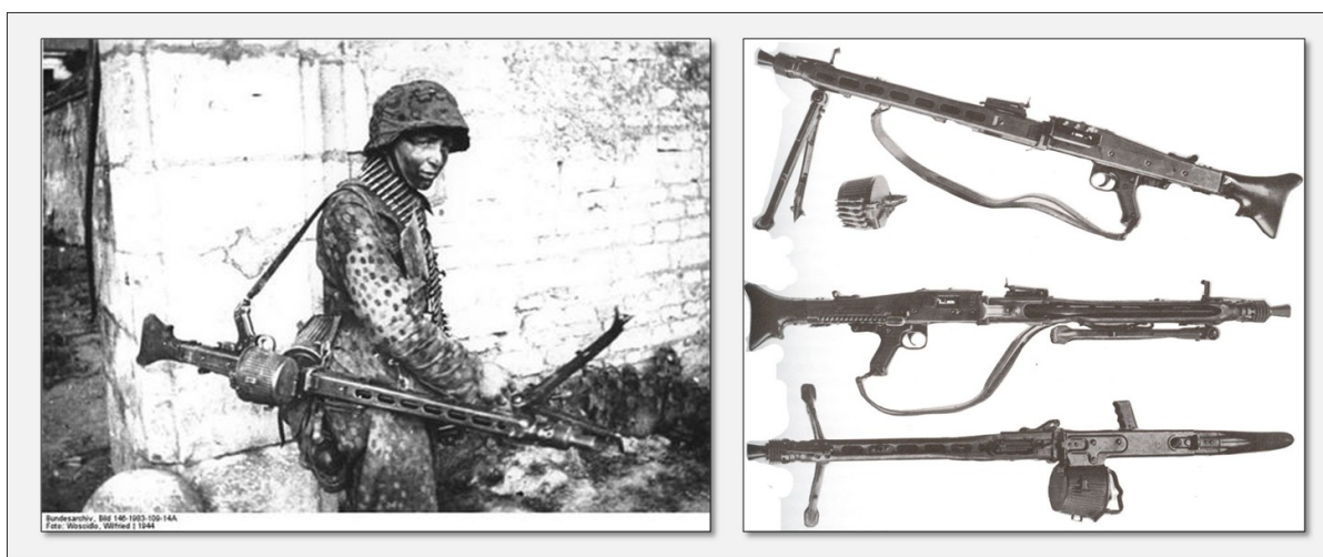
Fot. 27: Karabin MG42, fotografia i schemat. Źródło: http://www.ww2incolor.com , fotograf: Wilfred Woscidlo; http://ww2total.com , rys. autor nieznany. MG 42 stanowił prawdopodobnie najlepszy lekki karabin maszynowy drugiej wojny światowej. Jego szybkostrzelność wynosiła 1200 wystrzałów na minutę. Każda kompania piechoty dysponowała szesnastoma egzemplarzami tej broni. Dzięki niemu niemieckie wojsko mogło prowadzić bardzo skuteczny ogień osłonowy. Na zdjęciu z lewej strony widać młodego niemieckiego żołnierza z 12. Dywizji Pancerniej SS Hitlerjugend trzymającego MG42. Na obu zdjęciach karabin ten posiada podajnik bębnowy, który łatwo można było zastąpić pasem.
