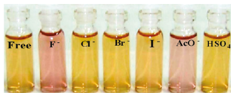
Rysunek 67: Zmiana barwy roztworu kompleksu Ru(II) i Os(II) pod wpływem różnych anionów Aniony takie jak chlorkowy, bromkowy, jodkowy czy wodorosiarczanowy(VI) nie powodują widocznej zmiany barwy.
