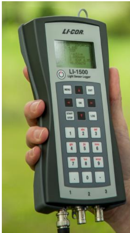
Ryc. 21. Czujnik światła LI-1500 Light Sensor Logger (wg Light Measurement 2015)
