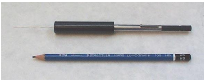
Rysunek 15. Holder SPME firmy Supleco
