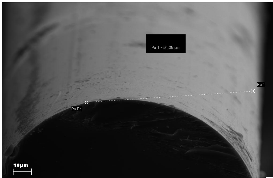
Rysunek 4. Zdjęcie mikroskopowe włókna kwarcowego, po przeprowadzeniu procesu oczyszczania i aktywacji powierzchni
