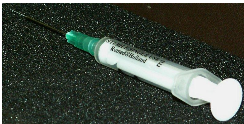
Rysunek 13(A-C). Włókno SPME umieszczone w polimerowej strzykawce
