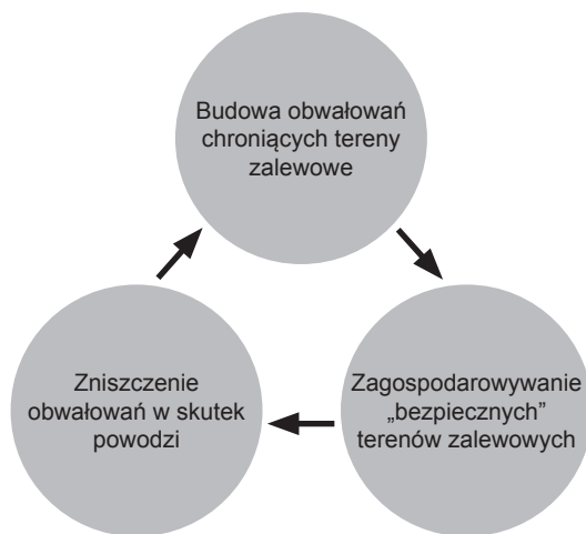
Ryc. 4. Uproszczony diagram obrazujący zjawisko „błędnego koła przeciwpowodziowego” (oprac. własne na podstawie: E. Owczarek-Nowak 2011)
