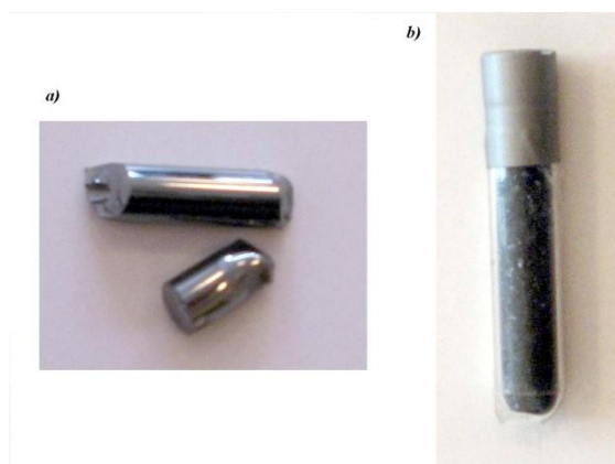
Rys.2.1 Postać badanych próbek: a) początkowa postać (wlewki cylindryczne), b) postać rozdrabiana w standardowej fiolce spektrometru.
