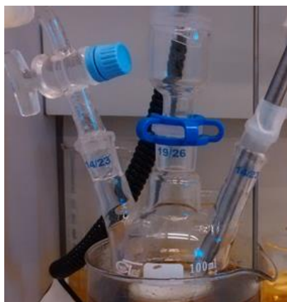
Rysunek 18. Układ reakcyjny wykorzystany do prowadzenia reakcji hydrosililowania w reaktorze okresowym (kolba trój szyjna). W prawej szyjce Kolby znajduje się sonda spektrometru IR in situ.
