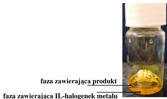
Rysunek 47. Dwufazowy układ po zakończeniu reakcji acylowania Friedela – Craftsa z wykorzystaniem cieczy jonowych jako nośnika AlCl 3 .
