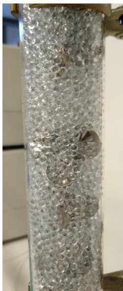
Rysunek 32. Wypełnienie usypowe kolumny - pierścienie Bialeckiego z przestrzeniami wypełnionymi szklanymi kulkami. Opracowanie własne.
