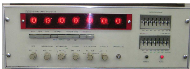
Rys. 38. Elektronowy przelicznik pojedynczych impulsów z urządzeniem do pomiarów czasowych
