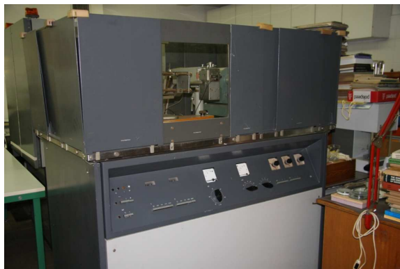
Rys. 25. Układ zasilania lampy rentgenowskiej
