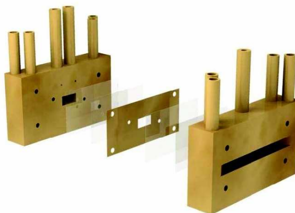
Rys. 34. Bloki mosiężne kuwety cieczowej: z kanałami do napełniania komory badaną cieczą i odpowietrzającym (lewy) oraz kanałem do termopary (prawy). Między tymi blokami widać wkładkę dystansową z wyciętym okienkiem i rowkami do napełniania i odpowietrzania
