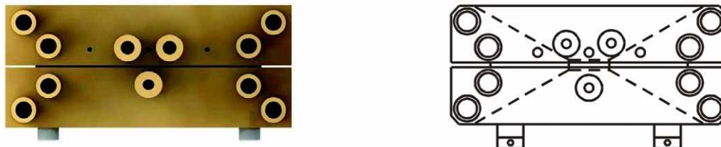
Rys. 33. Widok z góry na dwa bloki z mosiądzu kuwety cieczowej
