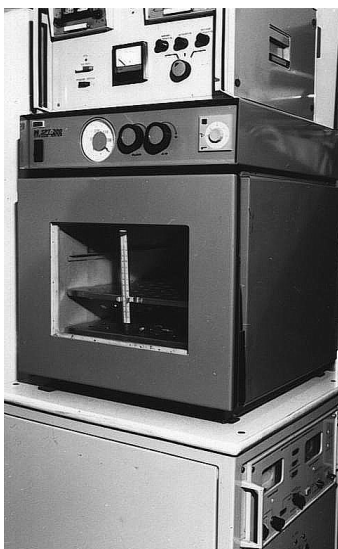
Rys. 35. Suszarka próżniowa do osuszania kuwety cieczowej ( T = 250^{\circ}C )
