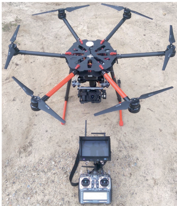
Ryc. 2. Bezzałogowa platforma powietrzna Tarot X6 wykorzystana w badaniu Fig. 2. Unmanned Aerial Vehicle Tarot X6 used in the study
