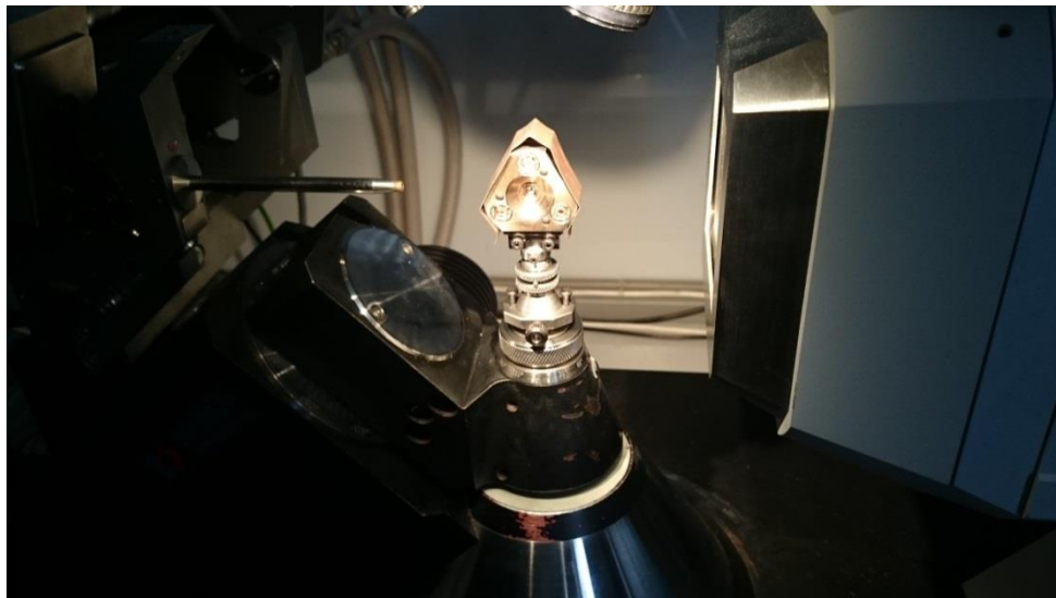
Rysunek 2.2.1 Komora diamentowa umieszczona na dyfraktometrze KUMA KM4CCD na główce goniometrycznej. Z prawej strony widoczny jest detektor CCD a z lewej kolimator oraz lampa rentgenowska.
