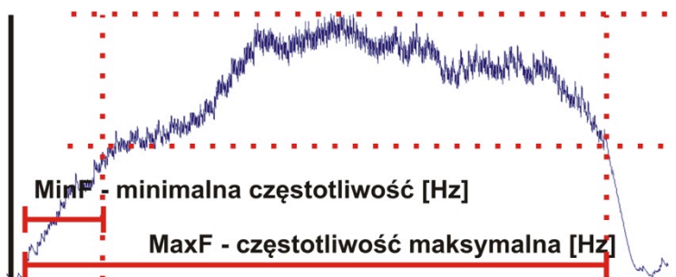
Ryc. 12. Graficzna prezentacja sposobu pomiaru minimalnej i maksymalnej częstotliwości [Hz].
