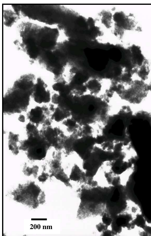
Rysunek 62. Żel \text{SiO}_2:\text{SnO}_2 1:0,1 kalcynowany w temperaturze 500^\circ\text{C} , w \text{O}_2
