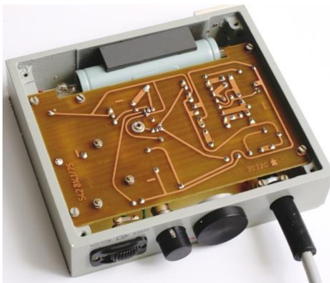
Rys. 39. Licznik proporcjonalny z otwartą pokrywą czołową (wypełniony mieszaniną Ar + 10 % metanu)
