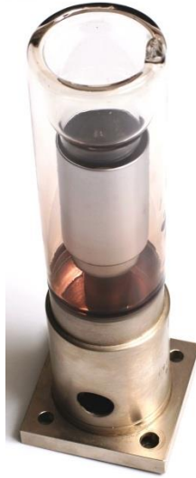
Rys. 30. Lampa rentgenowska zastosowana w badaniach jako źródło charakterystycznego promieniowania MoK_{\alpha} ( \lambda = 0.71069 \text{ \AA} )
