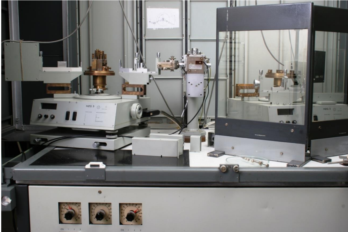
Rys. 33. Goniometr licznikowy – najważniejsza część dyfraktometru rentgenowskiego (widok ogólny). W tle widać lampę rentgenowską zamocowaną poziomo na kołpaku
