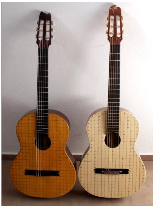
Rys. 4.7. Gitara z szyjką zamontowaną konwencjonalnie (z lewej) oraz gitara z szyjką zamontowaną pod kątem (z prawej). Na płytach wierzchnich widocznych jest 351 punktów pomiarowych wykorzystanych w teście modalnym
