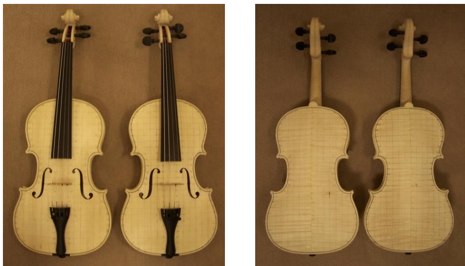
Rys. 5.3. Skrzypce A – replika instrumentu A. Stradivariego „Il Cremonese” (1715) – lewa strona fotografii, skrzypce B – instrument z pogrubioną płytą spodnią – prawa strona fotografii
