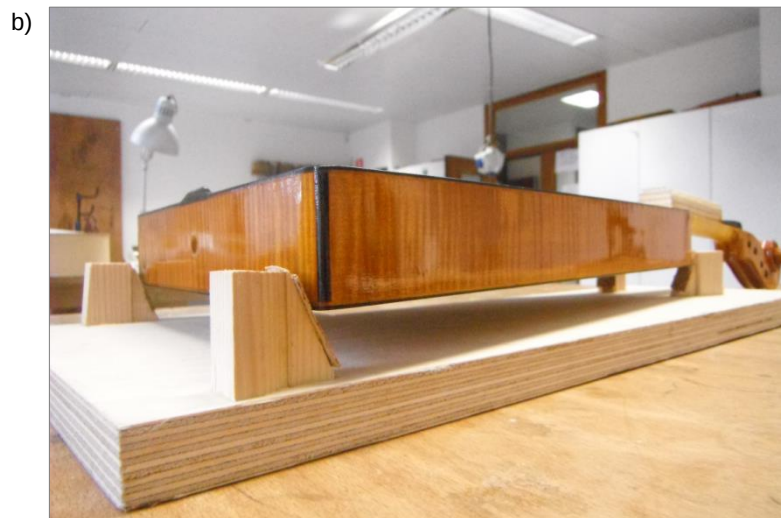
Rys. 5.20. a) sposób montowania skrzypiec trapezoidalnych (bez lakieru) w teście modalnym. Widoczna siatka pomiarowa i miejsce zamocowania akcelerometru; b) instrument pokryty lakierem (niebadany), bez strun, w uchwycie pomiarowym
