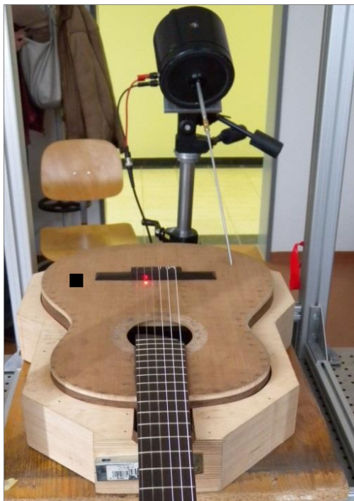
Rys. 4.2. Sposób zamontowania gitar do pomiarów dopplerowską wibrometrią laserową. Ta sama obejmą była użyta podczas testu modalnego
