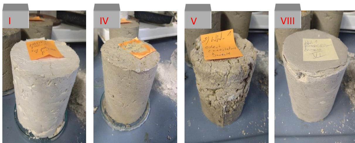
Rysunek 30. Przykładowe zdjęcia próbek kompozytów wykonanych z I - WP z produkcji mleka wapiennego I- szlamu fluorkowego, IV - WP z produkcji mleka wapiennego i pyłu z bypassu, V - WP z oczyszczania solanki i szlamu papierniczego, VII- WP z oczyszczania solanki oraz piasku i cementu
