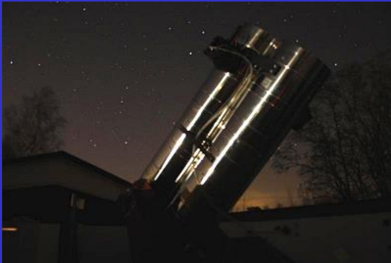
Podwójny teleskop spektroskopowy PST-1 (zbudowany przez inż. R. Baranowskiego)
