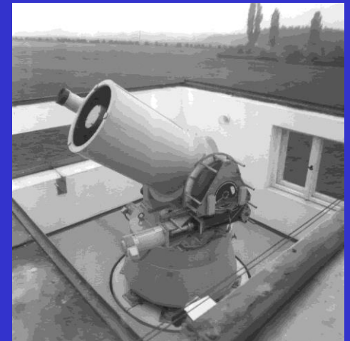
Dalmierz laserowy II generacji Zaprojektowany i budowany pod nadzorem zespołu pracowników OA UAM przez 7 firm
