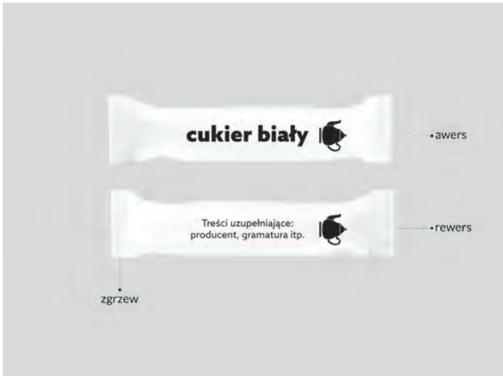
Ilustr. 19. Budowa saszetki typu stick .
