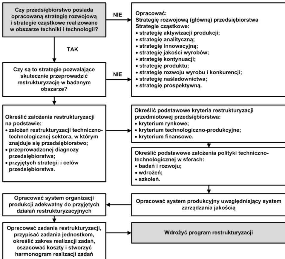
Procedura restrukturyzacji na obszarze techniki i technologii
