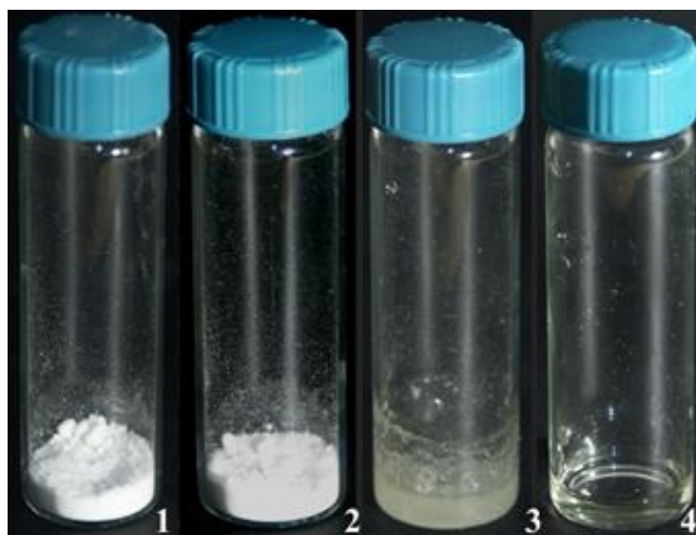
Rys. 48 Tworzenie mieszaniny eutektycznej [C_4C_1pyrr][BF_4] + [C_2C_1pyrr][NTf_2] , obserwowane w temperaturze pokojowej. (1) Czysty [C_4C_1pyrr][BF_4] ; (2) Czysty [C_2C_1pyrr][NTf_2] ; (3) 49,2 mol% [C_2C_1pyrr][NTf_2] i 50,8 mol% [C_4C_1pyrr][BF_4] , natychmiast po zmieszaniu; (4) 49,2 mol% [C_2C_1pyrr][NTf_2] i 50,8 mol% [C_4C_1pyrr][BF_4] , po całkowitym wymieszaniu.
