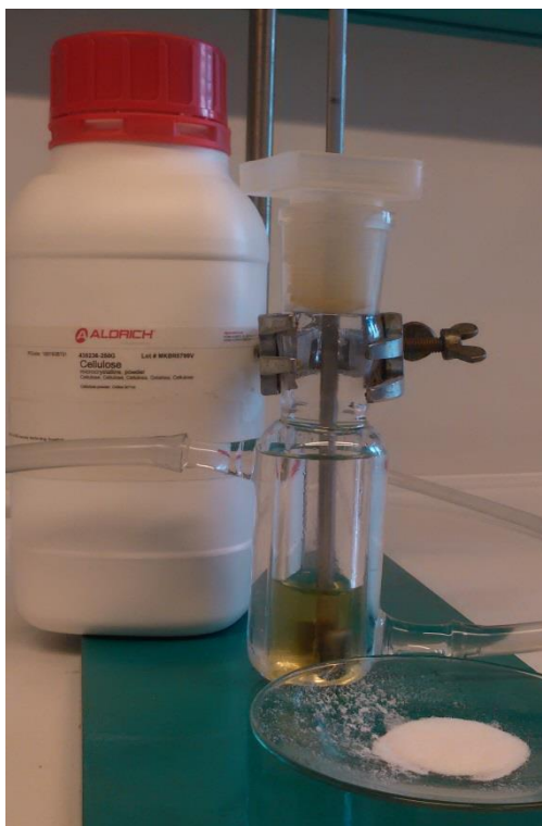
Rys. 19 Celuloza mikrokrystaliczna i układ stosowany do eksperymentów nad rozpuszczaniem celulozy w mieszaninach cieczy jonowych.
