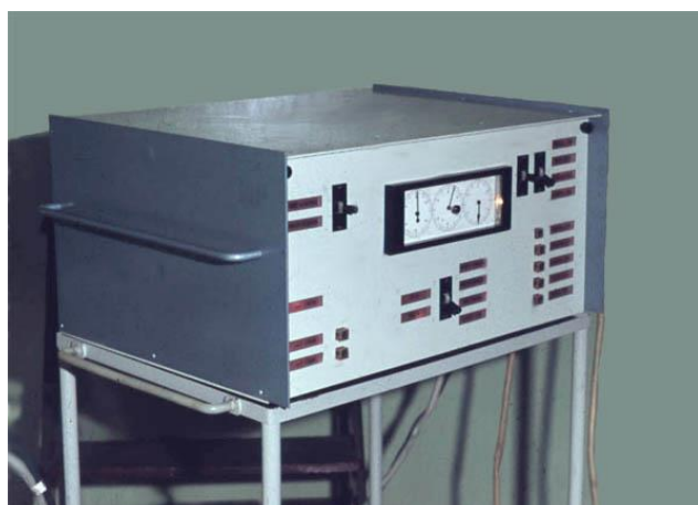
Blok automatyki sterujący pracą kamery satelitarnej
