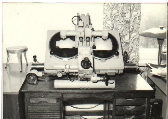
Plytomierz do pomiarów klisz fotograficznych obiektów gwiazdowych
