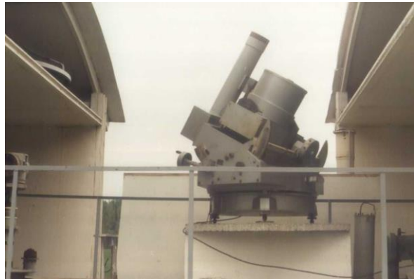
Dalmierz satelitarny I generacji produkcji rosyjskiej w Borowcu (na tych instrumentach przerabialiśmy „złotówki zbożowe”)
