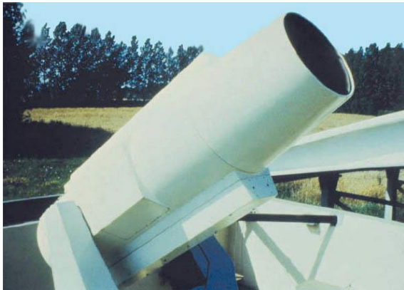
Automatyczna kamera satelitarna SBG w Borowcu
